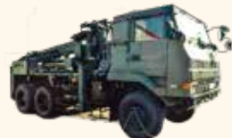
道路障害作業車
